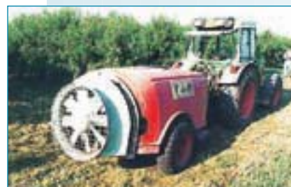
Irroratore tradizionale ad aeroconvezione (atomizzatore)
